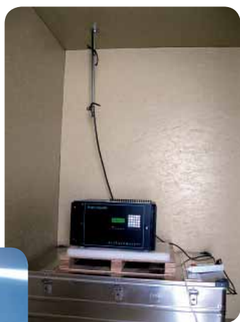
Afbeelding 1.5 : Links de CIMEL zonnefotometer die de totale extinctie van het zonlicht door aerosoldeeltjes meet, en rechts, de aethalometer, die de absorptie van het zonlicht door aerosolpartikels en de concentratie van zwarte koolstofdeeltjes meet.
