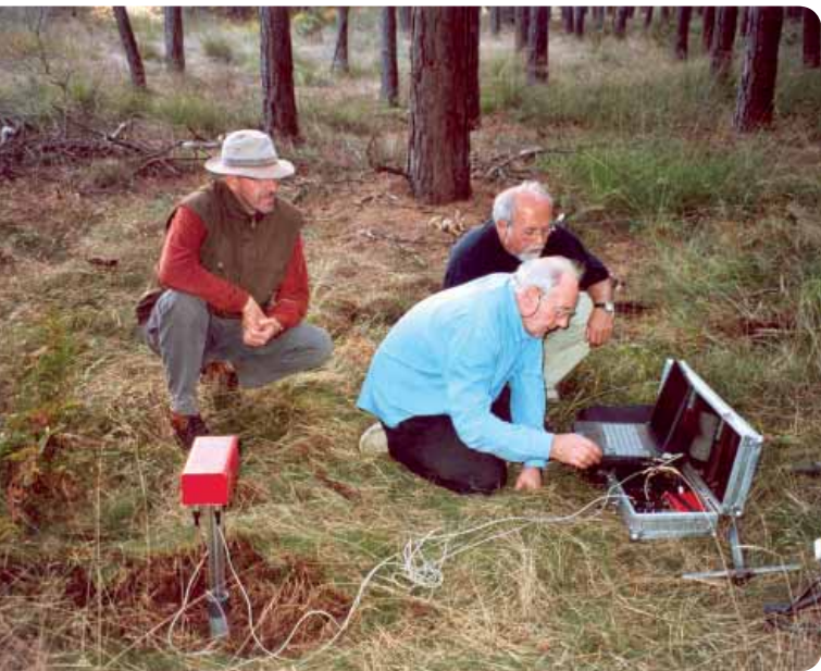
Afbeelding 2.11 : Meting van de magnetische susceptibiliteit volgens de diepte (van 0 tot 50 cm) in bosgrond in de buurt van Balen (provincie Antwerpen). De SM-400 sensor (vooraan links) meet de magnetische susceptibiliteit met grote spatiale resolutie en nauwkeurigheid (sensibiliteit 10 -5 SI) en detecteert de zones waarin de antropogene verontreiniging zich opstapelt.
