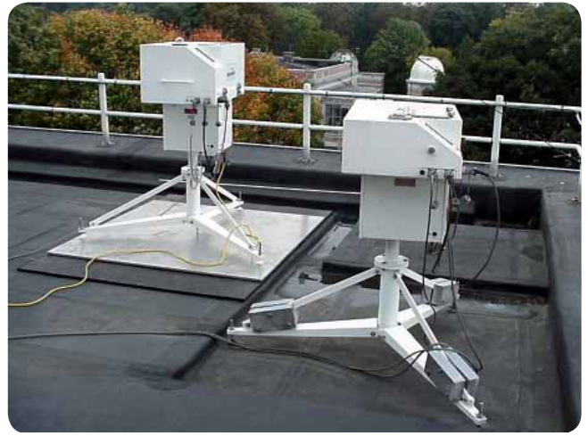
Afbeelding 4.3 : De Brewer-instrumenten 016 en 178 op het dak van het KMI voor waarnemingen van de dikte van de ozonlaag en de intensiteit van de UV-straling.
